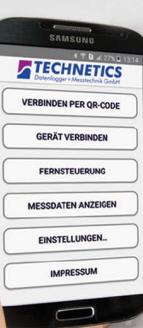
Möchten Sie bereits während der Druckprüfung eine Zwischenbetrachtung der Messergebnisse vornehmen, können Sie die Messreihen per **mikromec®** App auf Ihrem Android Smartphone abrufen. Zusätzlich verfügt die **mikromec®** App über eine Fernbedienungsfunktion mit der Sie das Prüfgerät direkt steuern können.
